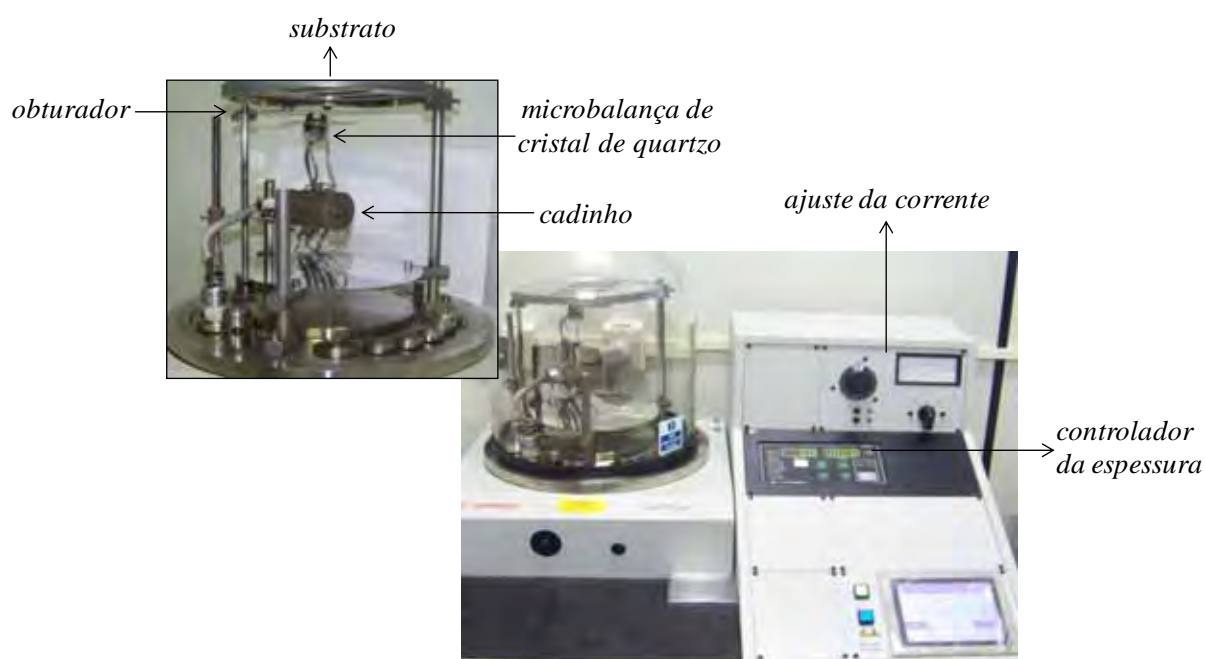
Figura 13. Evaporadora de materiais orgânicos Boc Edwards Auto 306 usada para crescimento dos filmes PVD. Na imagem são indicados os principais componentes do equipamento e detalhes do interior da câmara onde o processo de evaporação é realizado.
