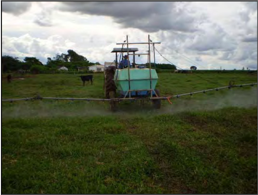
Figura 7. Aplicação da suspensão conidial de Metarhizium anisopliae na pastagem de Brachiaria decumbens , com pulverizador de barra.
