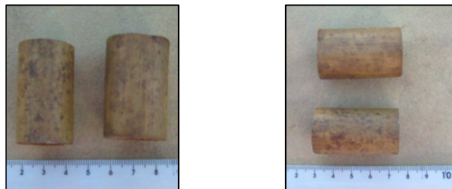
FIGURA 12. Fotos dos anéis de bambu utilizados como meio suporte no filtro anaeróbio de fluxo ascendente na partida e fases 1 e 2 e no filtro biológico percolador nos ensaios 1, 2, 3 e 4.
