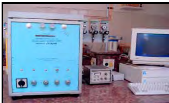
Figura 9. Cromatógrafo a gás para determinação de AGCC.
