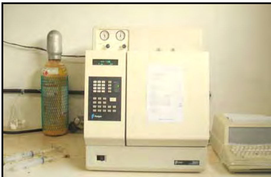
Figura 8. Cromatógrafo gasoso e seringa plástica contendo a amostra de gás a ser injetada.
