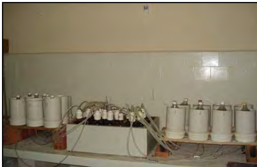
Figura 7. Garrafas com líquido ruminal colocadas em banho com temperatura controlada e os recipientes adaptados para o armazenamento de gás produzido.
