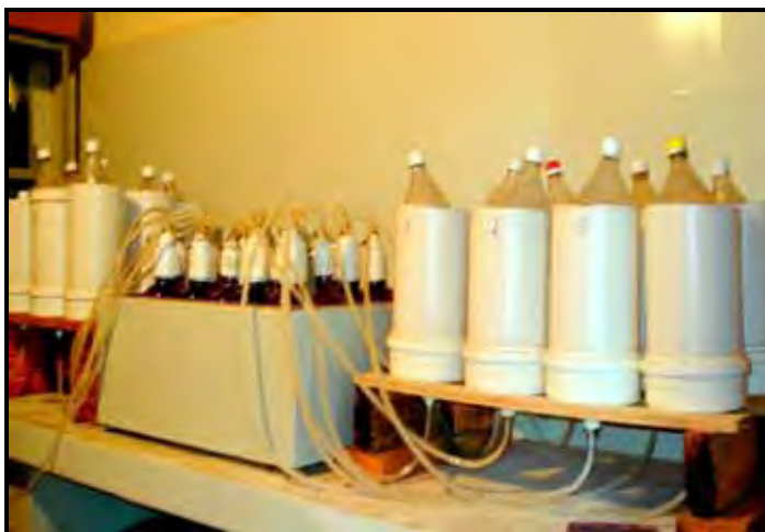
Figura 17. Garrafas com líquido ruminal colocadas em banho com temperatura controlada e os recipientes com o gás armazenado produzido.
