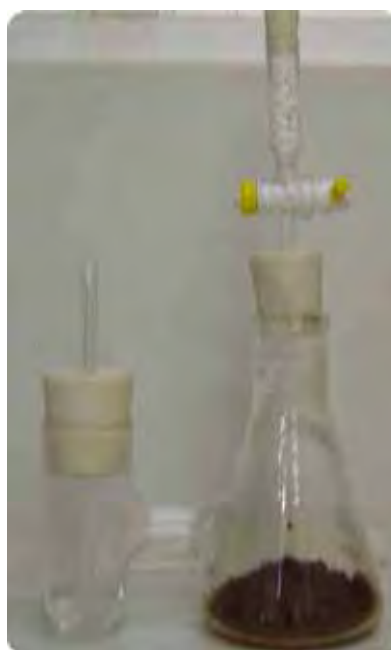
Figura 10 – Respirômetro de Bartha (Norma técnica L.6.350 da CETESB, 1990).
