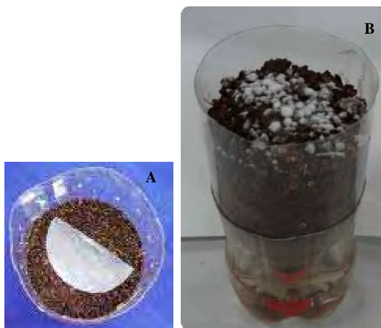
Figura 11. Coluna de solo: A- disposição do filme e B- coluna após 4 meses de tratamento.
