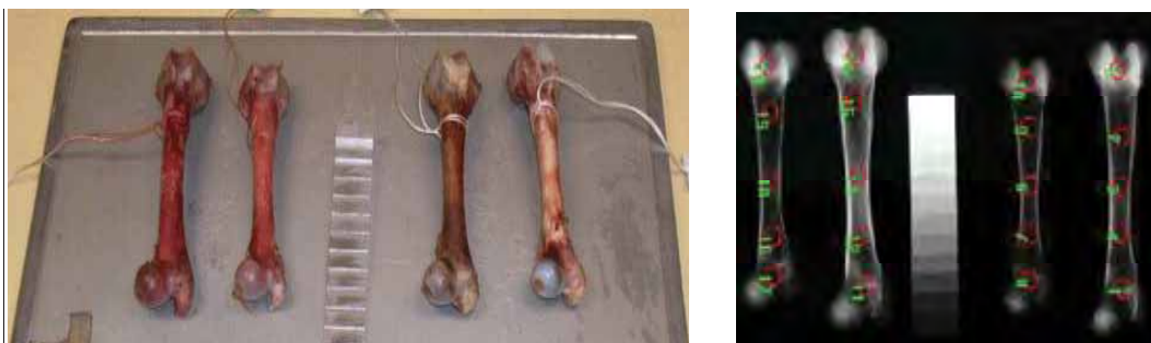
Figura 2. Exemplo de posicionamento dos ossos em placa de raios-X (à esquerda), imagem produzida após o procedimento realizado com pontos selecionados para leitura densitométrica (à direita)
