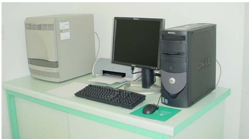
Figura 4 - Máquina de PCR em Tempo Real (7500 Real Time PCR System – Applied Biosystems)
