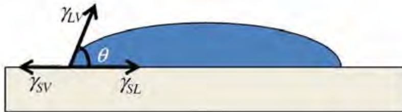
Figura 2.1- Ilustração do ângulo de contato ( \theta ). Quando a gota está em equilíbrio \theta é dado \cos \theta = (\gamma_{SV} - \gamma_{SL}) / \gamma_{LV} , onde \gamma_{LV} , \gamma_{SV} e \gamma_{SL} são as tensões superficiais nas interfaces líquido/vapor, sólido/vapor e sólido/líquido, respectivamente.
