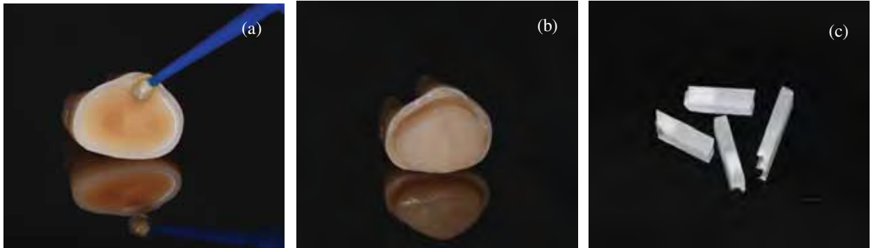
Figura 1.4 Procedimentos realizados somente no experimento três. (a) Aplicação do sistema adesivo, segundo a recomendação do fabricante. Observar o aspecto brilhante e homogêneo; (b) aspecto final da coroa reconstruída em resina composta; (c) espécimes com área de secção transversal de 0,81 \text{ mm}^2 para a realização do ensaio mecânico de microtração.
