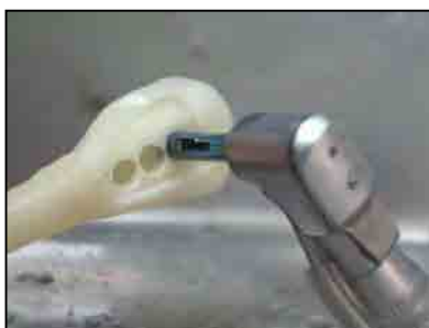
FIGURA 2: Obtenção dos espécimes utilizando broca trefina de titânio (2,7 mm de diâmetro interno, Impladonto – São Paulo, Brasil) em baixa rotação.
