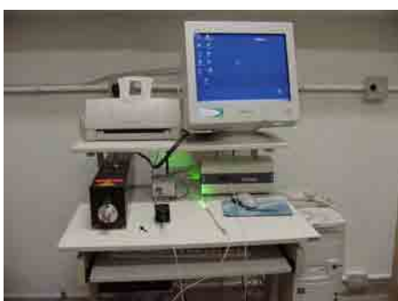
FIGURA 5 – Aparato experimental utilizado para leitura por fluorescência composto por um laser de excitação (532 nm), espectrômetro, computador com programa de aquisição LightView e uma sonda tipo Y.
