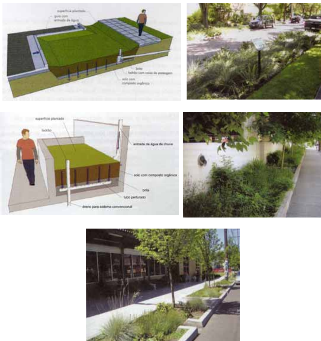
Figura 24: exemplos de jardins de chuva e canteiros pluviais Fonte: Cormier & Pellegrino (2008)
