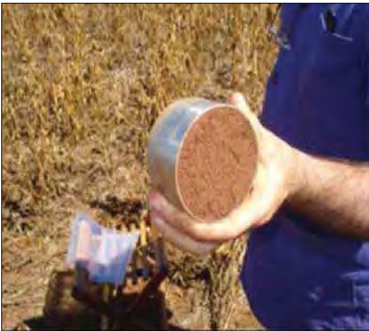
Figura 3. 18: Modelo de ensaio de amostra de solo em cilindro
