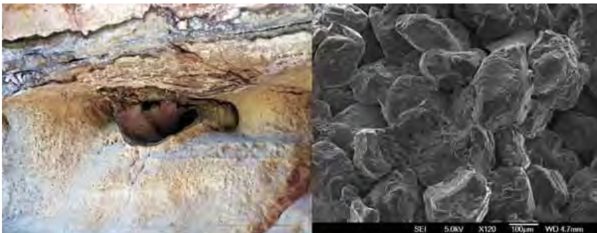
Figura 4.31: exemplo de crosta na gruta Kiogo-Brado, revestindo um antigo tubo, e uma imagem de MEV relacionada a crosta da Gruta Três Marias Central, mostrando a deposição secundária de minerais nos poros da rocha. Foto: Rubens Hardt.
