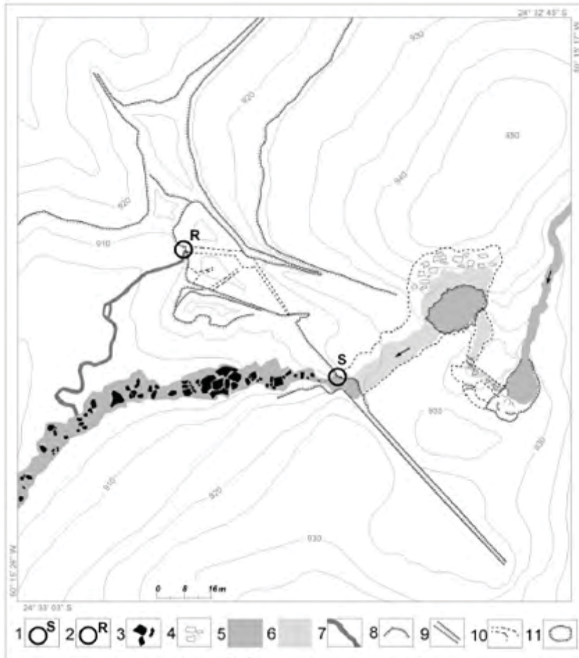
Fig 3.70. Legenda - 1: sumidouro; 2: ressurgência; 3: blocos rochosos na superfície do terreno; 4: blocos rochosos em cavidades subterrâneas; 5: águas superficiais (arroyos e lagos dentro das furnas); 6: águas subterrâneas; 7: novo percurso do Rio Quebra-Pedra; 8: escarpas; 9: fendas; 10: projeção do perímetro basal de cavidades subterrâneas; 11: furnas. Conforme Pontes et al. (2010, p. 12). Observe a captura no lado direito, por meio de um conduto, do Rio Quebra-Pedra.
