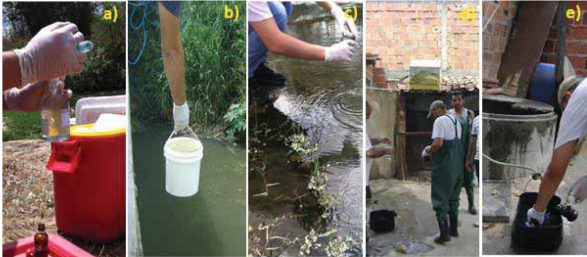
Figura 11 – a) Adição de reagentes fixantes utilizados para análises de oxigênio dissolvido; b) Recipiente utilizado para coleta nos pontos em pontes sobre o rio Cocó; c) Procedimento de amostragem para análises microbiológicas; d) Procedimento de amostragem realizados nos poços artesianos; e) Recipiente utilizado para coletas nos poços.
