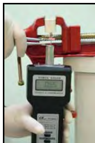
FIGURA 10 - Posicionamento do dispositivo para o teste de cisalhamento nos Grupos V e IV.
