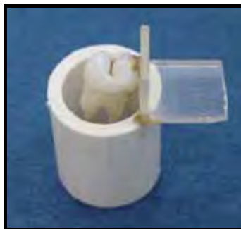
FIGURA 3 - Conjunto dente/esquadro fixado a um tubo de PVC.
