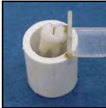
FIGURA 7 - Conjunto dente/esquadro fixado a um tubo de PVC.
