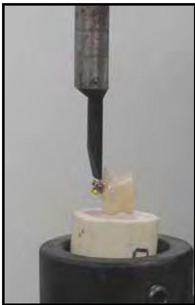
FIGURA 7 – Posicionamento do dispositivo para o teste de cisalhamento nos Grupos III e IV.
