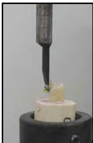
FIGURA 11 – Posicionamento do dispositivo para o teste de cisalhamento.
