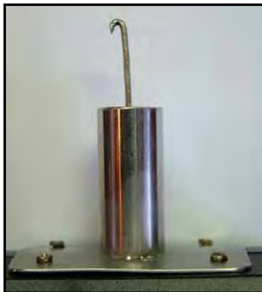
FIGURA 3 - Prolongamento da célula de carga fixado na parte superior do dinamômetro.
