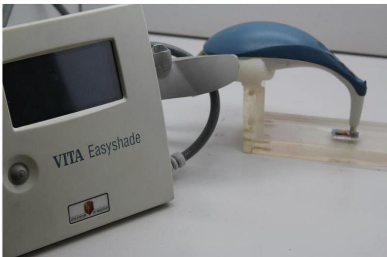
Figura 6 – Vista aproximada do espectrofotômetro adaptado ao posicionador, em posição de registro de cor dentária.
