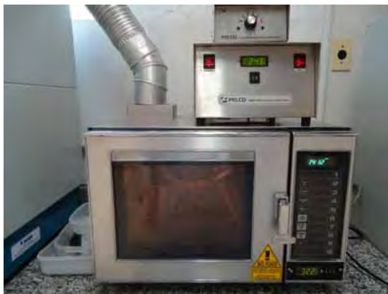
Figura 11 – Forno de micro-ondas utilizado para acelerar o processo de descalcificação das tíbias.
