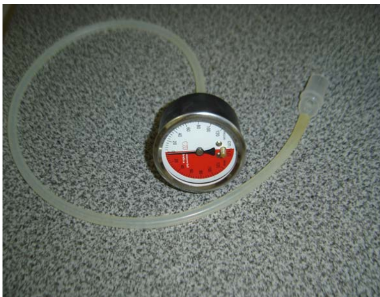
Figura I: Manovacuômetro (Marshalltown, Comercial Médica, Brasil)
