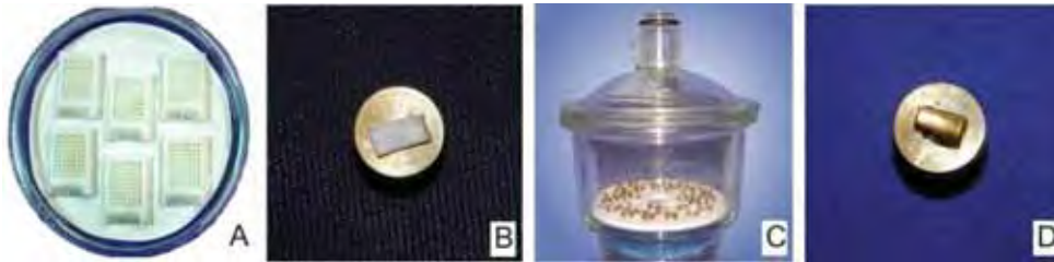
FIGURA 6. A) Secagem em papel de filtro. B) Espécime tratado, colado em “stub” metálico. C) Dessecador a vácuo. D) Espécime metalizado.
