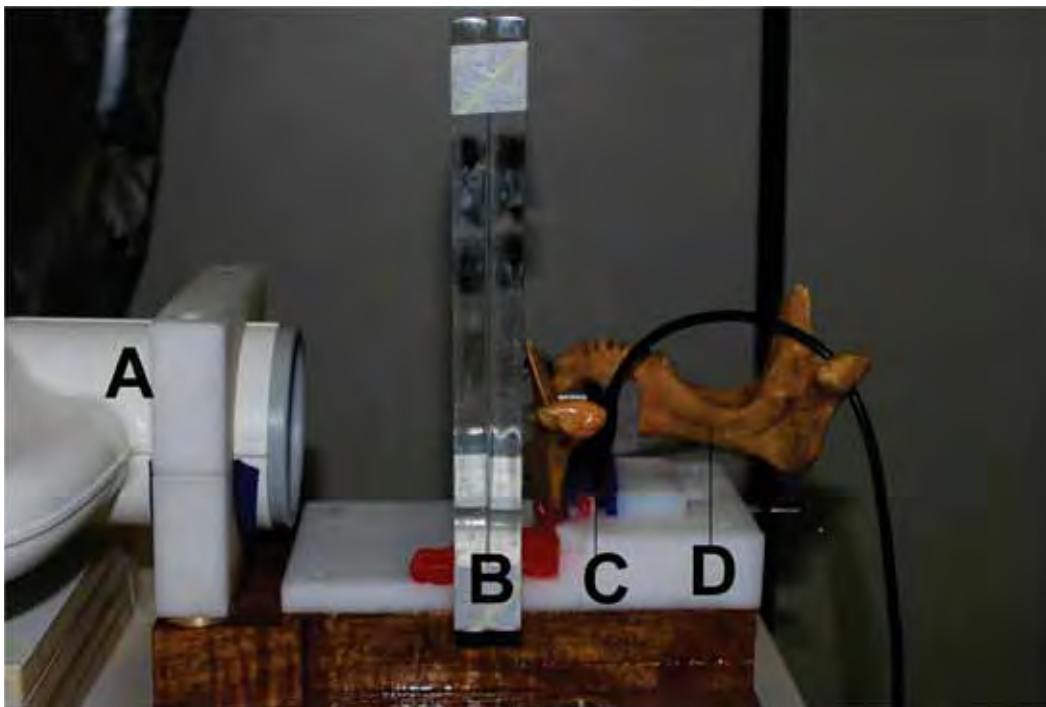
FIGURA 1 – Padronização da tomada radiográfica: A. Cilindro de raios x. B. Simulador de Tecido Mole/Placas de Acrílico. C. Sensor Visualix D. Mandíbula.
