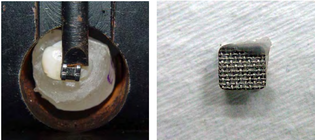
FIGURA 12 – À esquerda, detalhe do descolamento do braquete ortodôntico. À direita, o braquete descolado. Observar a resina remanescente.
