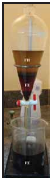
FIGURA 5.2 – Purificação do Extrato etanólico 96 % (v/v) bruto por Partição líquido-líquido (FE = Fração etanólica 40 % (v/v); FH = Fração hexânica).
