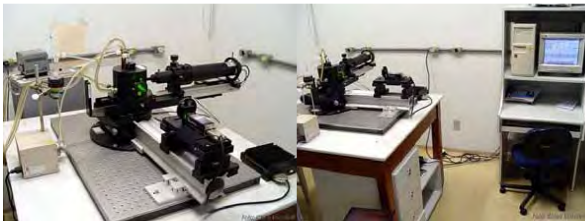
FIGURA 13. Esquema do aparelho utilizado para determinação do diâmetro das gotículas por espalhamento de luz.
