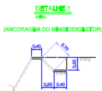
FIGURA 4 – Detalhe da ancoragem da planta para escavação do biodigestor tubular de propriedade intelectual de SANSUY S.A
