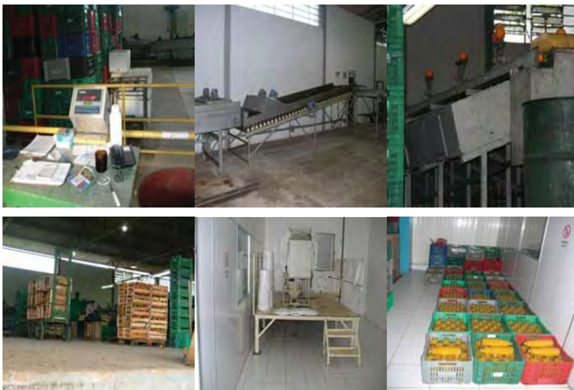
FOTO 28 – Sequência do processo de recepção e classificação de citros para a comercialização in natura e preparação das tangerinas sem classificação para transformação em sucos orgânicos da ECOCITRUS (Começando na 1ª linha, à esquerda, até o final)
