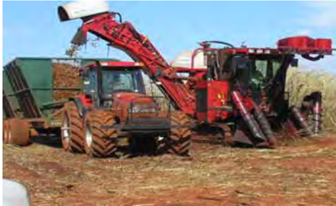
Foto 4 - Carregamento feito pela colhedeira diretamente no caminhão “julieta”
