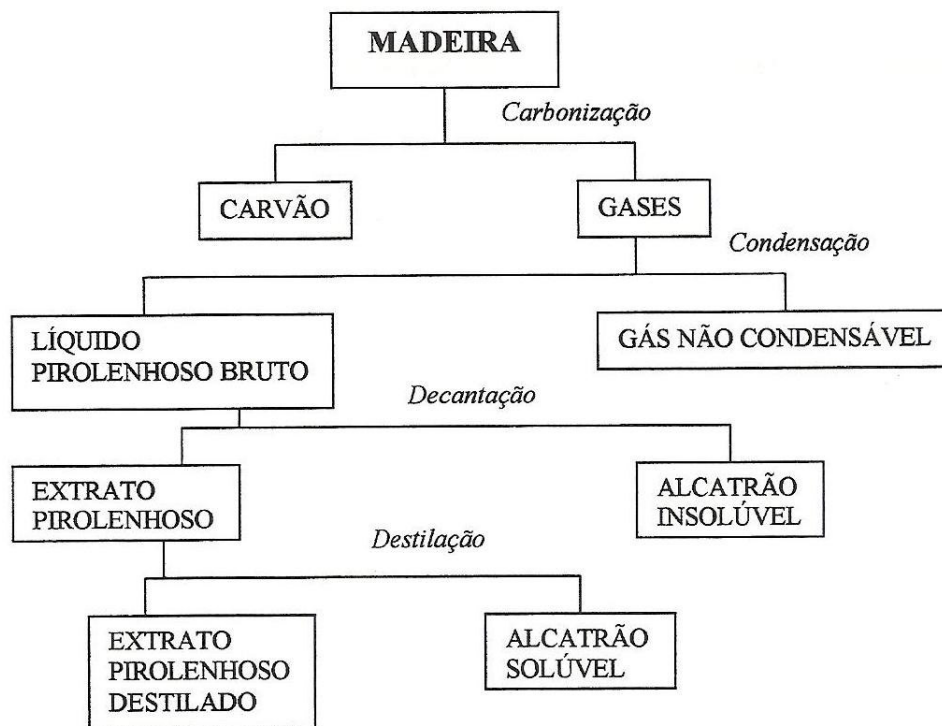
Figura 1. Esquema do processo de obtenção do extrato pirolenhoso destilado (MIYASAKA et al., 1999).
