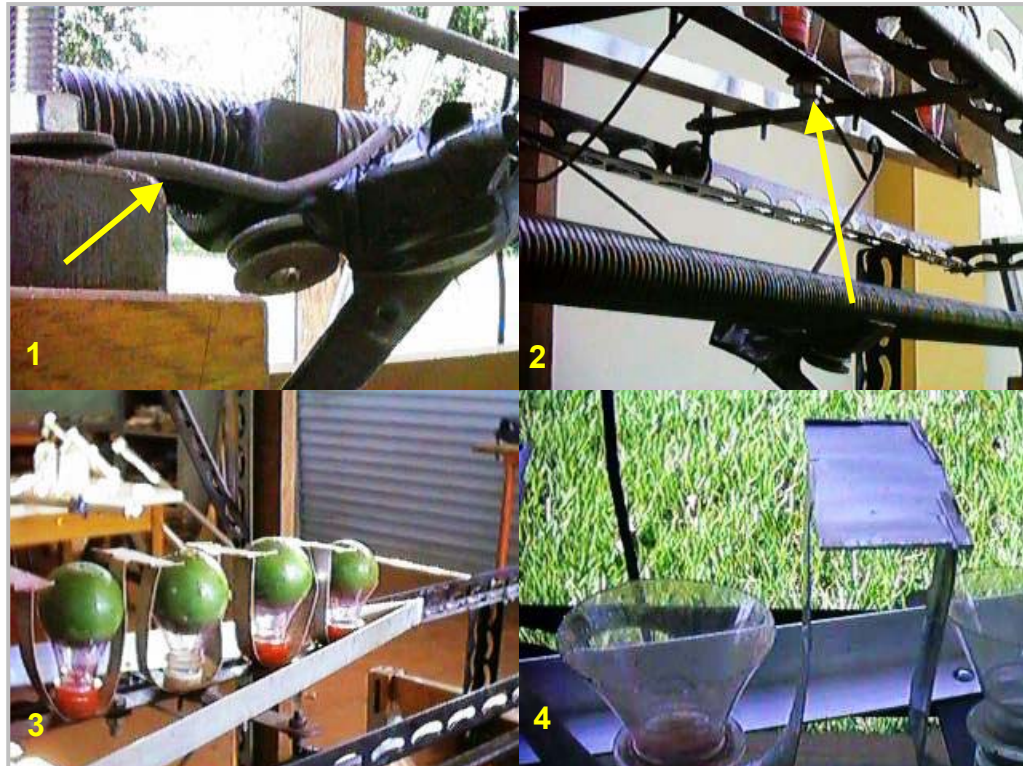
Figura 8. Aplicador de gotas para a caracterização da menor cobertura de pulverização necessária para controle de pragas, doenças e plantas daninhas; 1) Haste para limitação do curso do carrinho do suporte de frutos; 2) Rosca sem fim com ligação ao carrinho do suporte de frutos. 3) Frutos no suporte em experimento para determinação do diâmetro e mínimo número de gotas necessário para controle do ácaro da leprose. 4) Suporte dos frutos e de papéis sensíveis.
