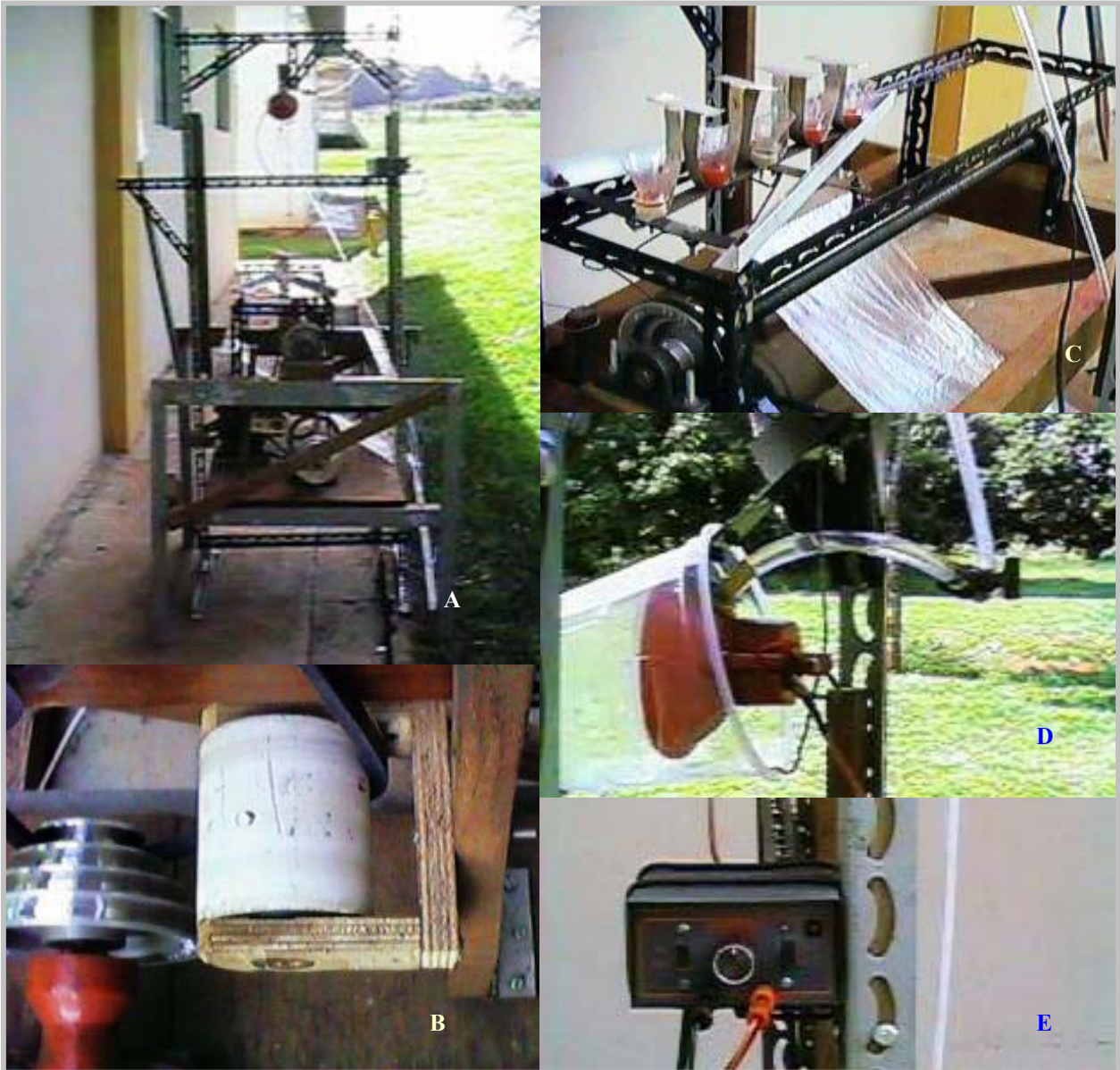
Figura 7. A) Aplicador de gotas para a caracterização da cobertura mínima para o controle de pragas, doenças e plantas daninhas; B) Esticador da correia e polia motora para variação da velocidade do “carrinho” (suporte de frutos e do papel sensível) para diferentes números de gotas por \text{cm}^2 ; C) Suporte dos frutos e dos papéis sensíveis; D) Bico rotativo com protetor para permitir a saída de gotas somente em direção ao alvo; E) Potenciômetro para variação da velocidade do bico rotativo, para alteração do diâmetro das gotas.
