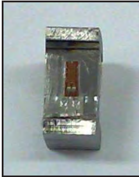
FIGURA 26 – Célula de carga com os extensômetros acoplados em suas laterais
