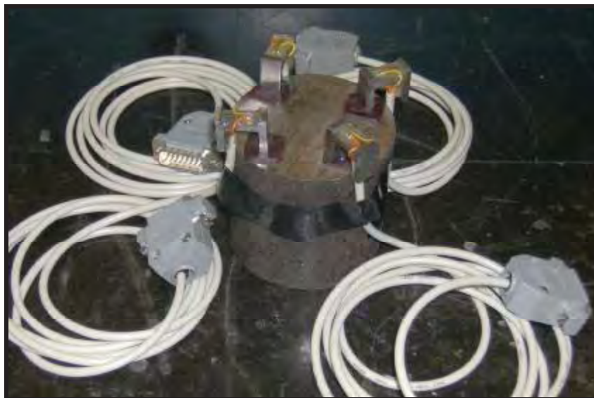
FIGURA 27 – Células de carga no processo de soldagem dos cabos com respectivos conectores
