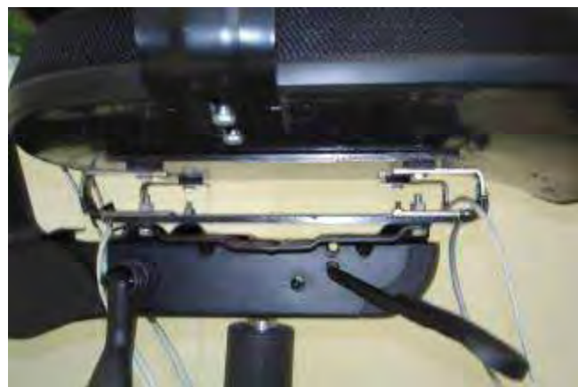
Figura 32 – Células de carga da parte de trás e da frente do assento, da esquerda para direita, respectivamente, na cadeira instrumentada (RESENDE, 2006).
