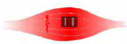
Figura 24 – A melhor localização do eletrodo é entre o ponto motor (ou zona de inervação) e a inserção do tendão, com as superfícies de detecção dispostas em uma intersecção com o maior número de fibras possível (DELSYS, 2006).
