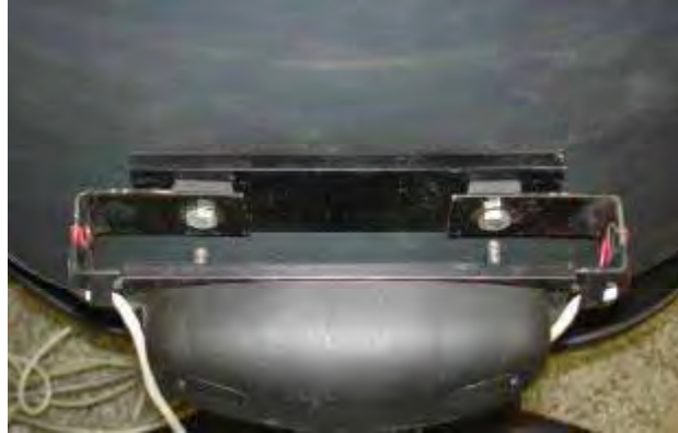
Figura 33 – Célula de carga do encosto da cadeira instrumentada (RESENDE, 2006).
