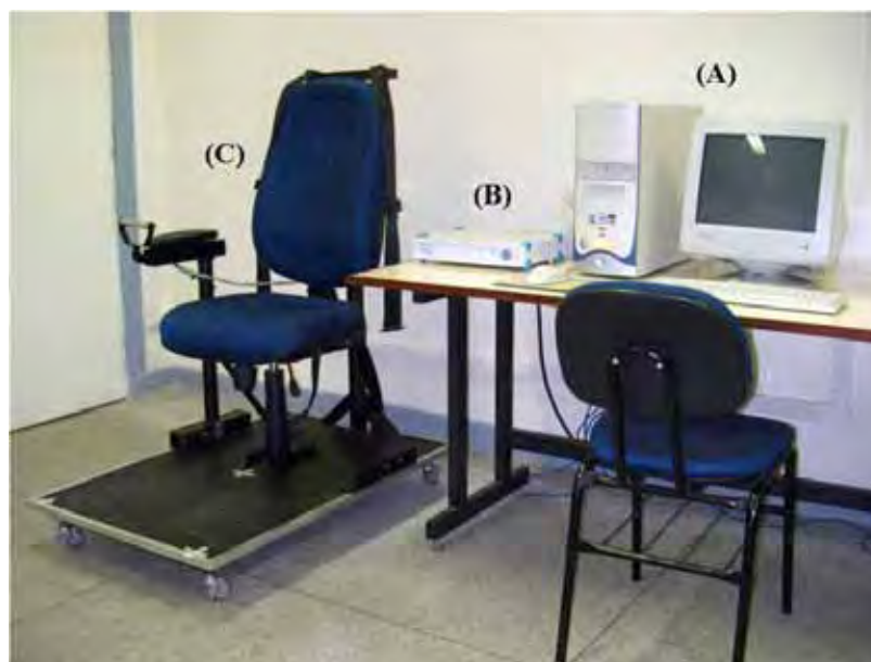
Figura 18 – DME modificado de Cortez (2008): (A) computador, (B) Spider 8 e (C) estação de medição de força.
