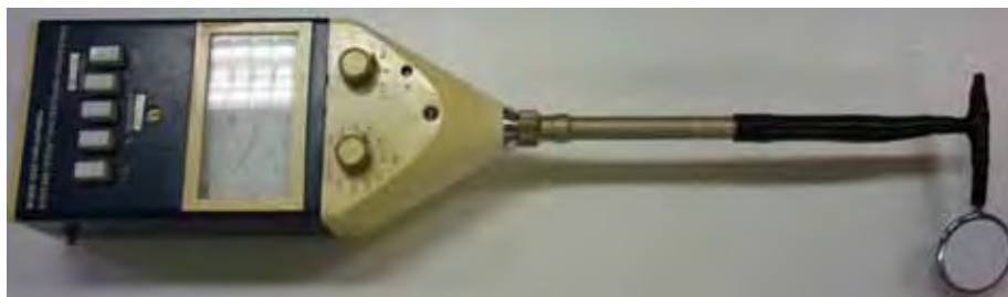
Figura 14 – Montagem do sistema do estetoscópio com o decibelímetro.
