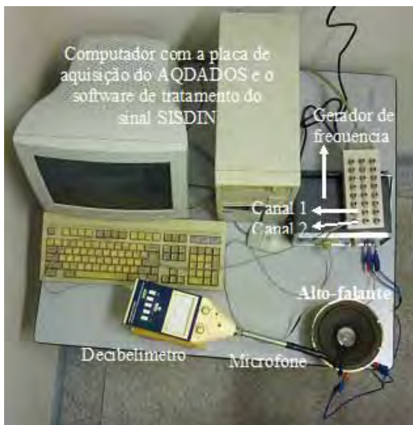
Figura 21 – Bancada experimental para identificar a sensibilidade do sistema de aquisição de sinal acústico
