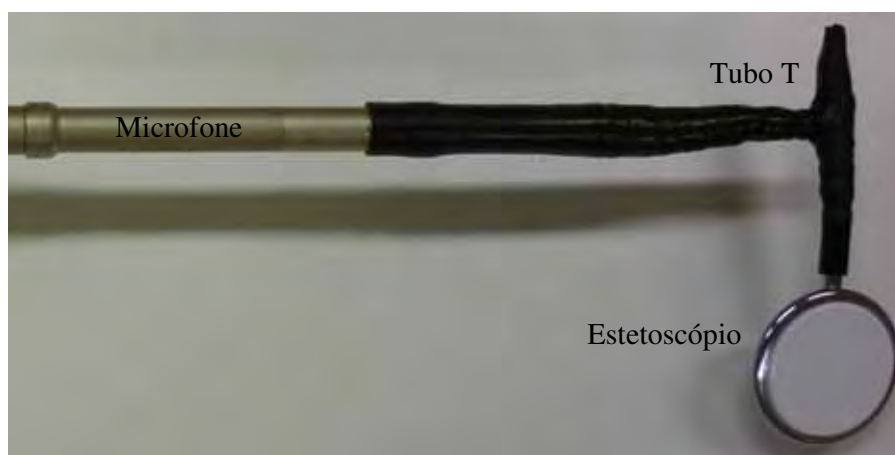
Figura 13 – Estetoscópio adaptado para o microfone.
