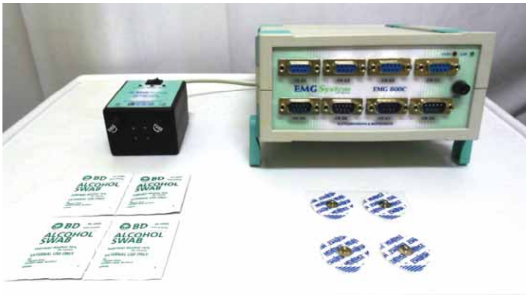
Figura 8 – Bancada com o eletromiógrafo, bateria, sachês de álcool isopropílico e os eletrodos.
