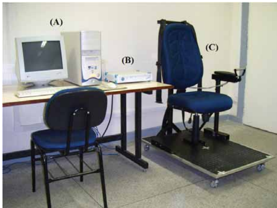
Figura 6 - Sistema de aquisição: (A) computador, (B) sistema de aquisição e condicionamento de sinais modelo SPIDER 8 e (C) estação de medição de força (CORTEZ, 2008).
