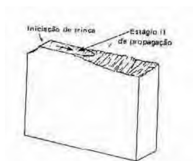
Figura (2.9) - Superfície de fratura em fadiga – esquemática (CAMARGO,1995).
