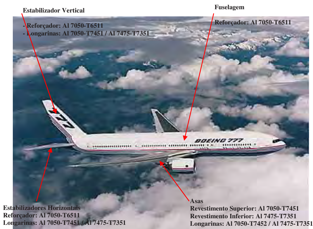
Figura (2.1) – Principais aplicações das ligas da série 7000 nas estruturas aeronáuticas civis (adaptado de ROSATO, 2003).
