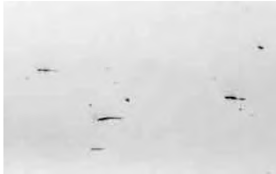
Figura 4.1 - Inclusões no aço ABNT-1050.
