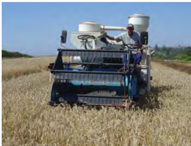
Figura 9. Colhedora de parcelas (Marca WINTERSTEIGER SEEDMECH – Gesellschaft m.b.h, modelo A-4910 Ried/Áustria – Fabr. n° 1400-1998-1105, Type-NM-ELITE).
