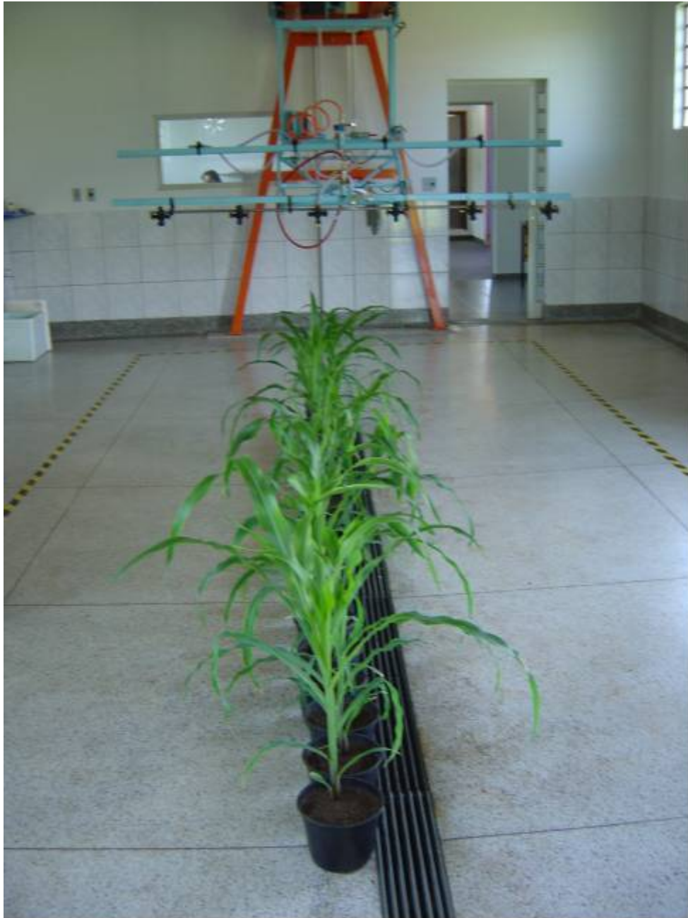
Figura 3. Pulverização em ambiente controlado ( 22\pm 2^{\circ}\text{C} ; UR 68\pm 2\% ) do entomopatógeno Steinernema sp. para o controle das lagartas de Spodoptera frugiperda , terceiro ínstar, após infestação artificial nas folhas centrais das plantas de milho.
