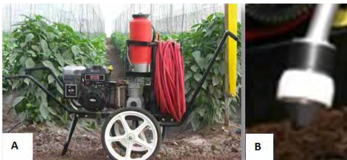
Figura 2. Foto Ilustrativa. A) Equipamento semiestacionário motorizado de jato lançado, marca ESS, modelo MBP. B) Detalhe do bocal eletrostático (ESS, 2011).
