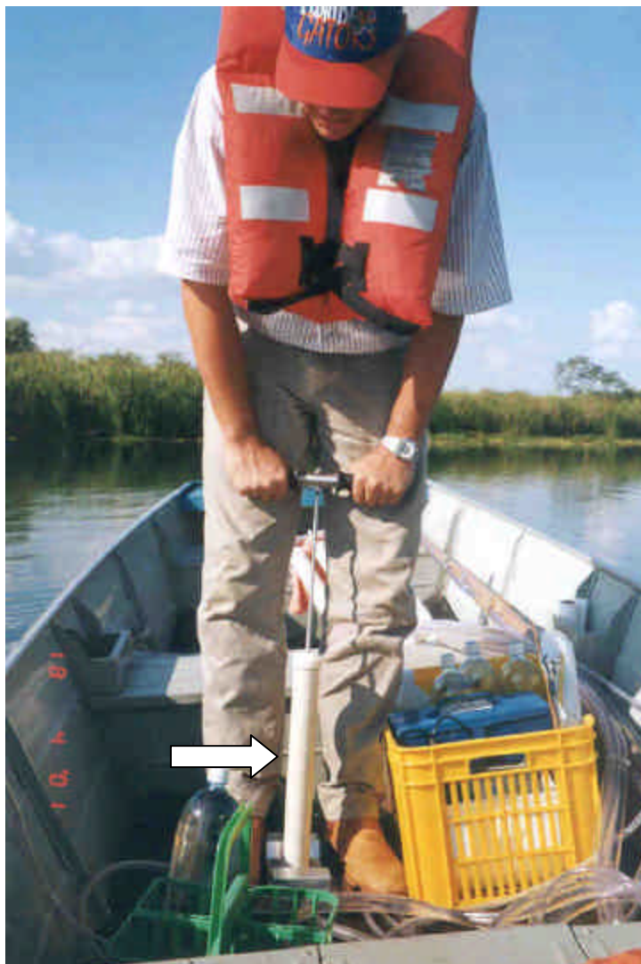
Figura 4. Coletor de fluxo contínuo para amostragem de água.
