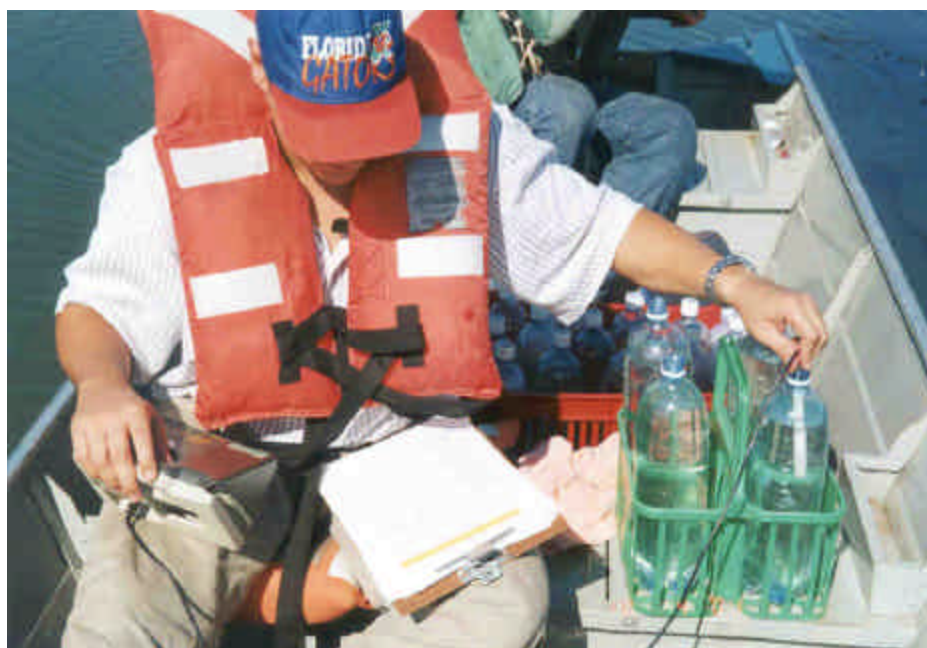
Figura 6. Leitura de oxigênio dissolvido e temperatura da água no momento da coleta.
