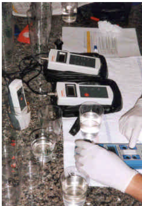
Figura 7. Leitura de pH, turbidez, condutividade e potencial de oxiredução.
