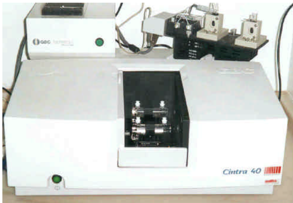
Figura 9. Espectrofotômetro e cubetas utilizados nos scans das amostras.
