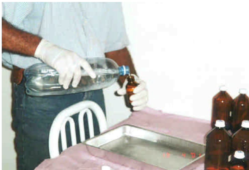
Figura 8. Amostra colocada em vidros com ácido para conservação.
