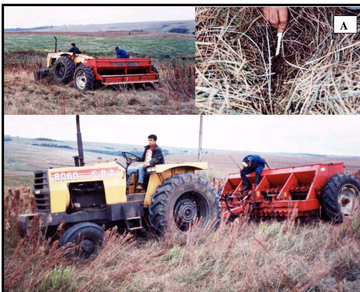
Figura 6. Implantação de lavoura de aveia-preta ( Avena sativa L.) em área de PDCN, utilizando semeadora modelo TD-300 da Semeato. A) Detalhe do corte da palhada para deposição do adubo e da semente.
