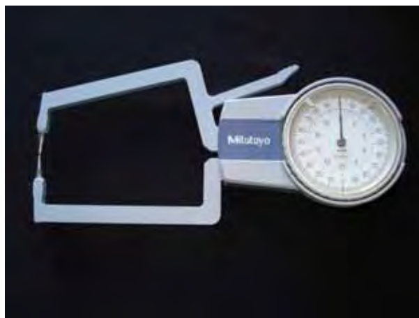
FIGURA 1- Medidor com relógio comparador para medidas externas, modelo 209-601, Mitutoyo.
