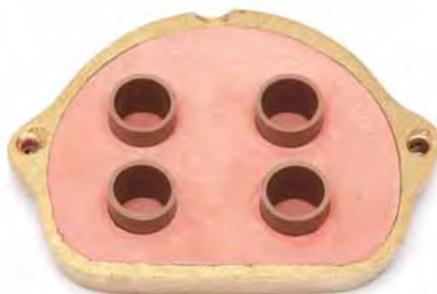
FIGURA 44 - Cilindros de PVC após a eliminação da cera.
