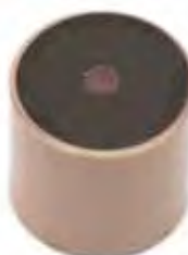
FIGURA 46 - Superfície de união delimitada com etiqueta adesiva.
