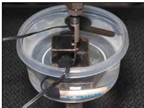
FIGURA 55 - Ensaio mecânico sendo realizado em água a 37\pm 1,0^{\circ}\text{C} .
