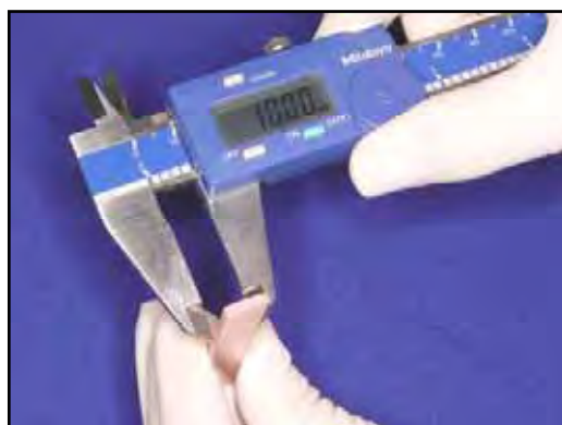
FIGURA 33 - Mensuração do corpo-de-prova com paquímetro.
