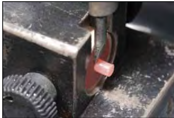
FIGURA 54 - Cinzel posicionado na interface de união.
