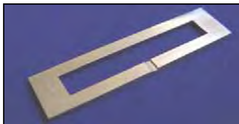
FIGURA 25 - Matriz metálica vazada (64x 10 x 3,3 mm).
