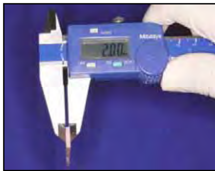
FIGURA 35 - Lâmina da resina L sendo mensurada com paquímetro.
