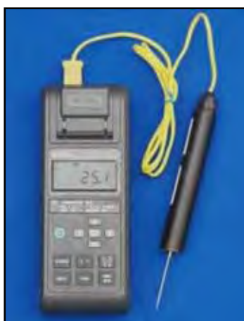
FIGURA 1 - Termopar do tipo K conectado ao termômetro digital.
