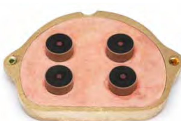
FIGURA 53 - Superfícies de união delimitadas com etiquetas adesivas.
