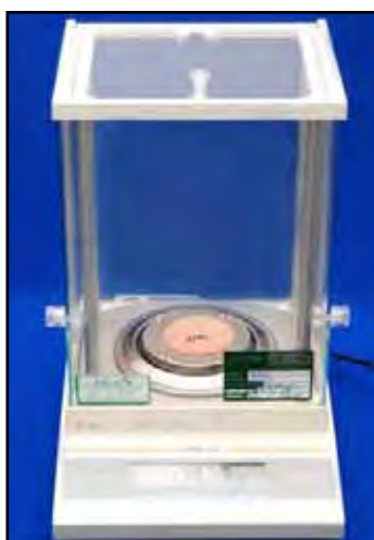
FIGURA 12 - Pesagem do corpo-de-prova.
