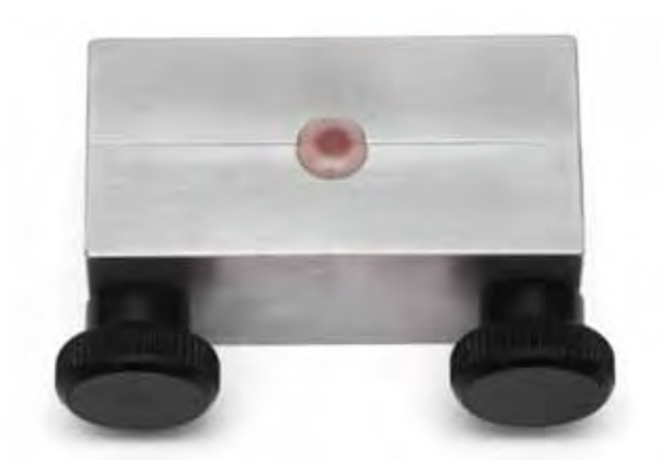
FIGURA 49 - Material reembasador inserido no orifício central da matriz.
