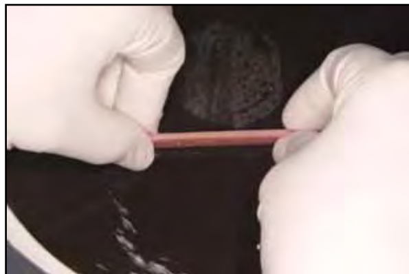
FIGURA 32 - Remoção dos excessos laterais em politriz.
