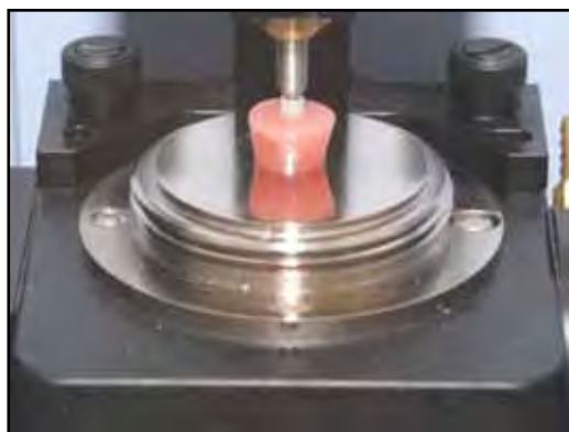
FIGURA 8 - Corpo-de-prova posicionado sobre a superfície do cristal.
