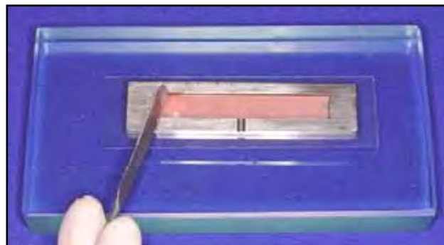
FIGURA 37 - Inserção do material reembasador sobre lâmina da resina L.
