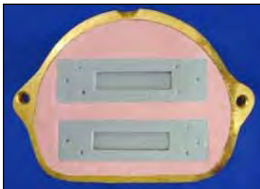
FIGURA 20 - Moldes em silicone incluídos na base da mufla.
