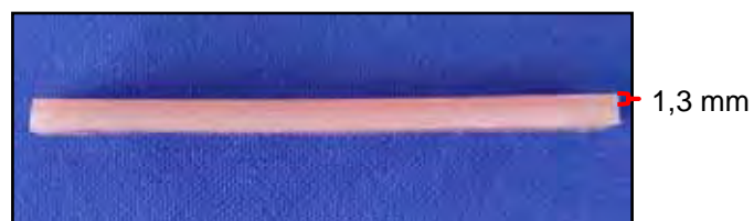
FIGURA 38 - Vista lateral do corpo-de-prova reembasado, com 1,3 mm de material reembasador.
