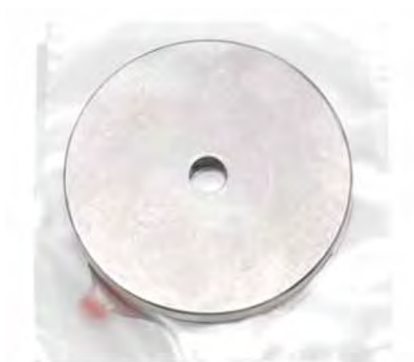
FIGURA 5 - Tampa posicionada, com as folhas de nylon interpostas.
