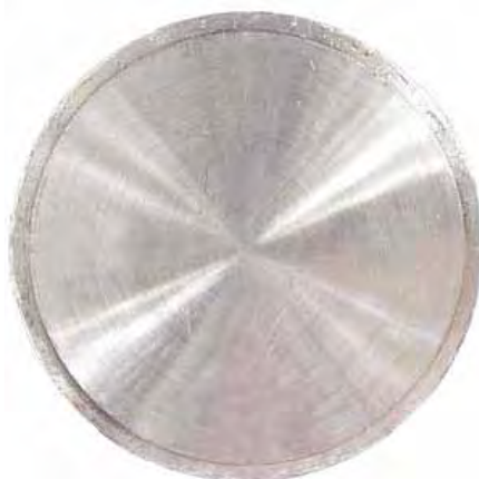
FIGURA 10 - Matriz metálica circular (50 x 0,5 mm).
