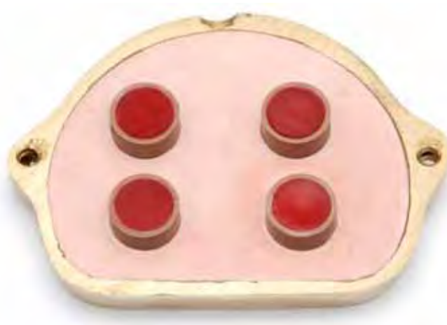
FIGURA 43 - Cilindros de PVC incluídos na base da mufla.
