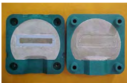
FIGURA 8 - Padrão metálico incluído em mufla.
