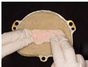
FIGURA 9 - Condensação da resina acrílica na fase plástica no interior do molde de silicone para obtenção do espécime em formato ISO/FDIS 1567.
