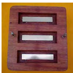
FIGURA 6 - Matriz de madeira utilizada para inclusão do padrão metálico em silicone.
