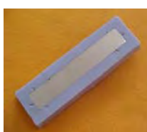
FIGURA 7 - Conjunto silicone/ padrão metálico após completa polimerização do silicone e remoção da matriz de madeira.
