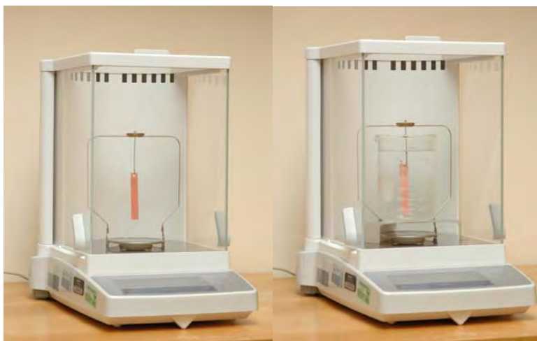
FIGURA 21 - A- Pesagem do espécime formato ISO no ar; B- Pesagem do espécime na água.
