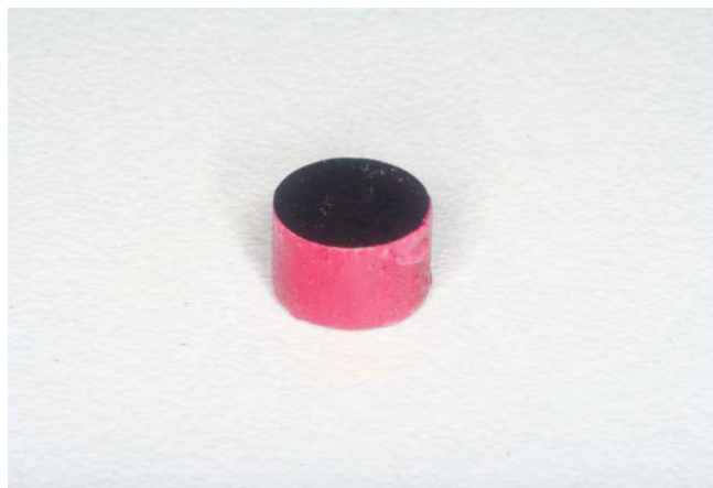
FIGURA 6 – Corpo-de-prova com as superfícies isoladas.
