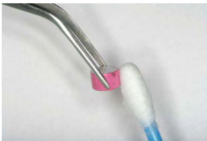
FIGURA 8 – Limpeza das superfícies impermeabilizadas com esmalte de unha com auxílio de mini-swab estéril.
