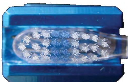
FIGURA 4 – Escova com cabeça seccionada, posicionada em dispositivo da máquina de escovação.
