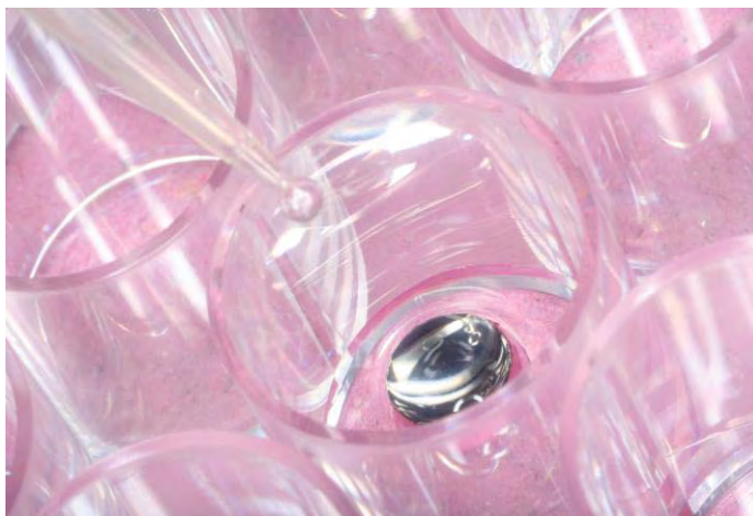
FIGURA 7 – Corpo-de-prova sendo lavado com 0,6 mL de solução salina por meio do gotejamento com o auxílio de micropipeta.
