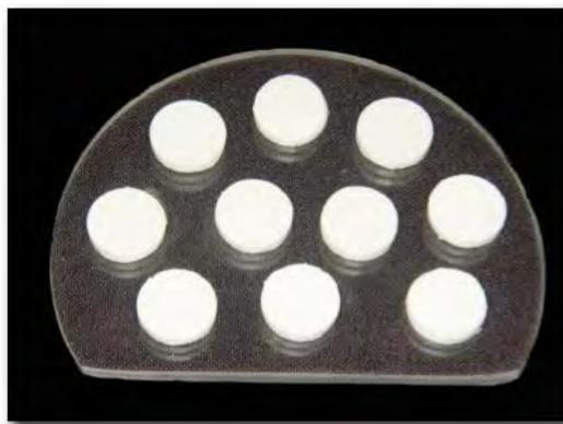
FIGURA 3- Discos de sílica fixados sobre uma lâmina de vidro.
