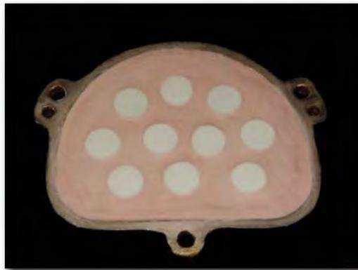
FIGURA 5- Preenchimento dos espaços existentes entre os discos de silicona com gesso pedra tipo IV.
