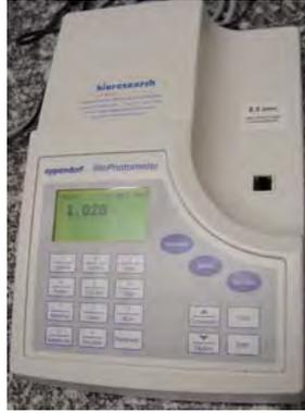
FIGURA 11- Monitoramento da turvação da suspensão por densidade óptica (DO) em espectrofotômetro.
