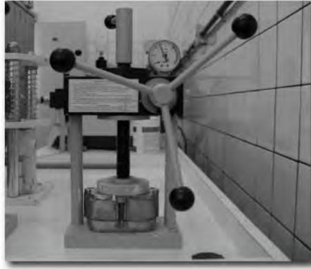
FIGURA 8- Prensagem da resina acrílica por um período de 30 minutos.
