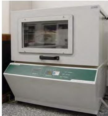
FIGURA 13- Incubadora utilizada no estudo (Incubadora 430 RDB Nova Ética).
