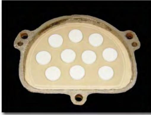
FIGURA 4- Inclusão do conjunto discos de silicona/lâmina de vidro em mufla metálica com gesso pedra tipo III.
