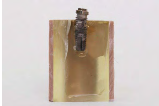
FIGURA 24 - DEFORMAÇÃO DO IMPLANTE, NA REGIÃO DO SEU PESCOÇO. FIGURA 25 - DEFORMAÇÃO DO PARAFUSO.
