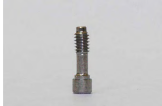
FIGURA 24 - DEFORMAÇÃO DO IMPLANTE, NA REGIÃO DO SEU PESCOÇO. FIGURA 25 - DEFORMAÇÃO DO PARAFUSO.
