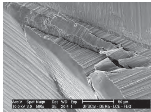
FIGURA 39 - OBSERVAÇÃO EM MAIOR AUMENTO DA FIGURA 38. AMASSAMENTOS COM PERDA DE ESTRUTURA. (AUMENTO: 500x)
