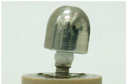
FIGURA 26 - PILAR DE ZIRCÔNIA E LINHA DE FRATURA ENTRE PARAFUSO E A PLATAFORMA DO IMPLANTE. FIGURA 27 - FRATURA COMPLETA EM PILAR DE ZIRCÔNIA.
