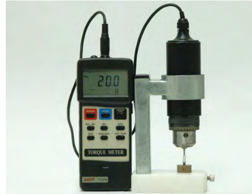
FIGURA 14 - TORQUE APLICADO PARA O PILAR DE ZIRCÔNIA (20 Ncm).
