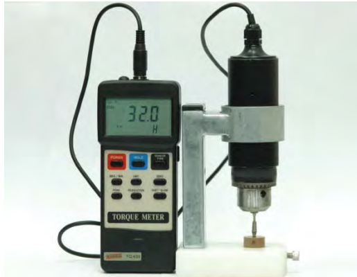
FIGURA 13 - TORQUE APLICADO PARA OS PILARES METÁLICOS (32 Ncm).
