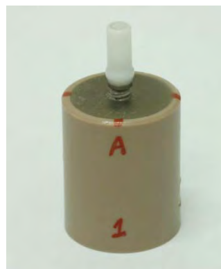
FIGURA 16 - POSICIONAMENTO DO PILAR PARA AFERIÇÃO DO DESAJUSTE VERTICAL.
