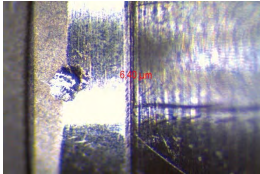
FIGURA 28 - AFERIÇÃO DO DESAJUSTE VERTICAL EM PILAR DE TITÂNIO. A ESQUERDA DA INTERFACE O IMPLANTE E A DIREITA O PILAR. (AUMENTO: 60x)
