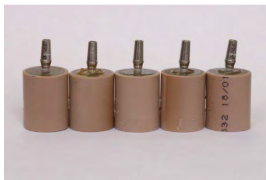
FIGURA 23 - PILARES DE TITÂNIO APÓS TESTE DE RESISTÊNCIA ESTÁTICA.
