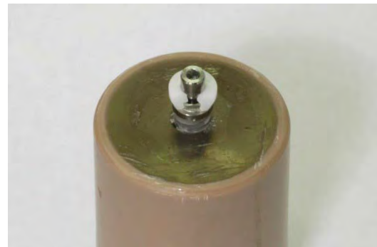
FIGURA 26 - PILAR DE ZIRCÔNIA E LINHA DE FRATURA ENTRE PARAFUSO E A PLATAFORMA DO IMPLANTE. FIGURA 27 - FRATURA COMPLETA EM PILAR DE ZIRCÔNIA.
