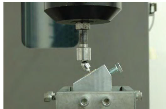
FIGURA 12 - POSICIONAMENTO DE CORPO DE PROVA DE ACORDO COM NORMA ISO 14801-2007.
