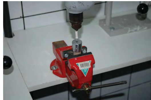
FIGURA 4 – PROCEDIMENTO PARA PERFURAÇÃO DOS CILINDROS DE PVC PREENCHIDOS COM RESINA EPÓXICA.
