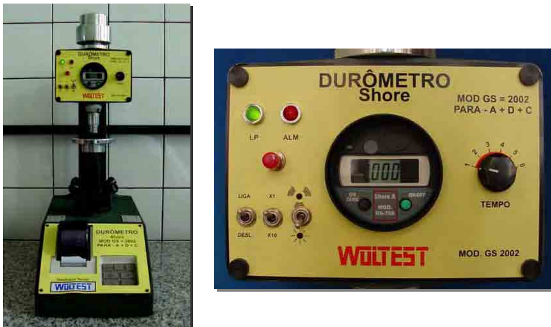
FIGURAS 23 e 24 - Durômetro Shore A e painel de controle.
