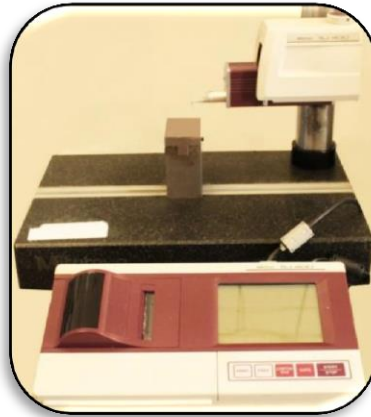
Figura 4- Rugosímetro Mitutoyo SJ 400. Araraquara, 2013.
