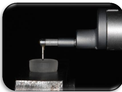
Figura 5- Mensuração da rugosidade superficial (Ra - \mu\text{m} ) dos corpos de prova. Araraquara, 2013.
