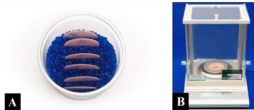
Figura 21 - A) Corpos-de-prova em sílica gel. B) Pesagem do corpo-de-prova.
