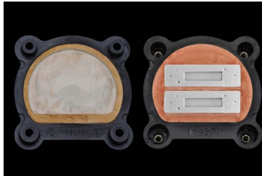
Figura 2 - Moldes de silicone incluídos na base da mufla.
