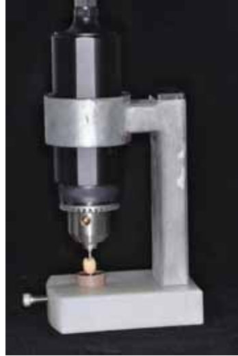
Figura 27 – Dispositivo para fixação do torquímetro e da coroa.
