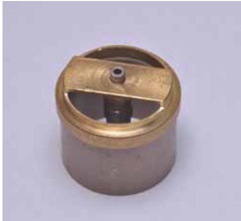
Figura 26 – Dispositivo para inclusão do implante no tubo de PVC.
