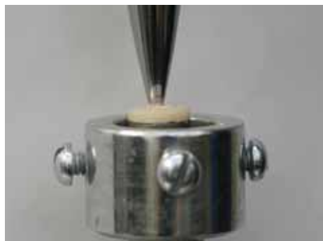
Figura 15 – Corpo-de-prova mantido em posição para o ensaio mecânico.
