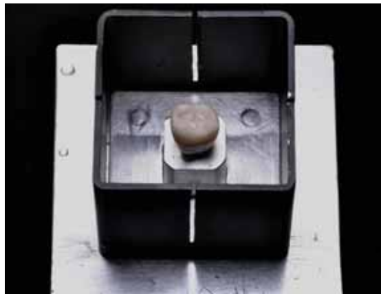
Figura 20 – Caixa metálica encaixada na base da matriz.
