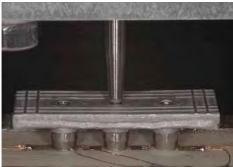
FIGURA 26 - ponta para aplicação de carga
