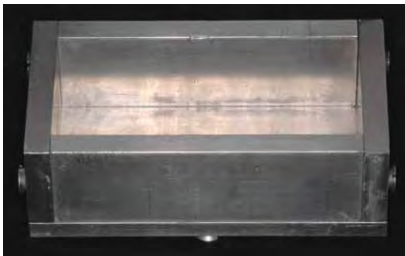
FIGURA 2 - Matriz metálica montada
