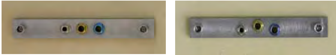
FIGURA 12 – Matriz em alumínio fixa no bloco e os anéis adaptáveis. O anel prata é compatível para a fresa helicoidal de 2mm, o anel amarelo é compatível para a fresa de 3mm e o anel azul é compatível para a fresa de 3.15mm. a) matriz linear, b) compensada
