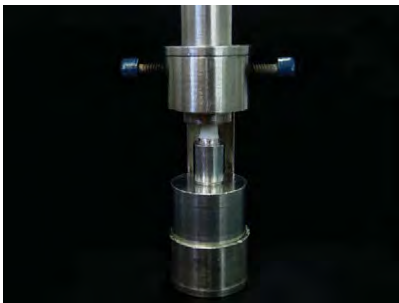
Figura 10 – Dispositivo para fixação da coroa cerâmica no conjunto troquel metálico, base cilíndrica metálica, troquel metálico, coroa cerâmica, parafusos laterais de fixação do êmbolo e êmbolo.
